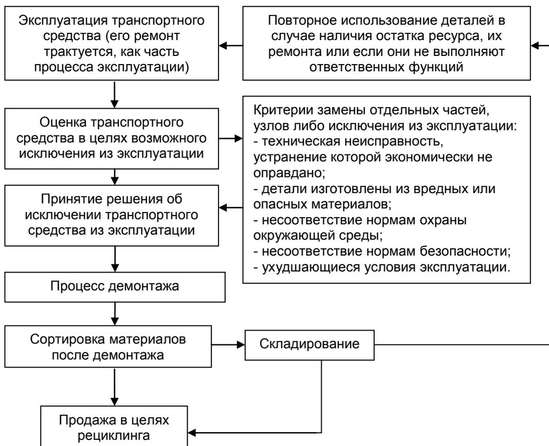
Рис. 4. Алгоритм исключения транспортного средства из эксплуатации
