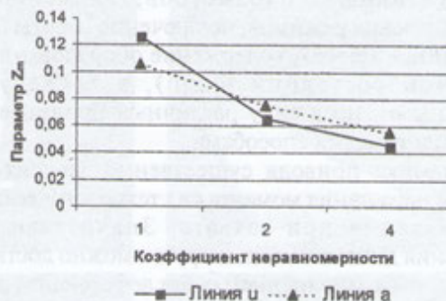
Рис. 2. Зависимость параметра z_m от коэффициента неравномерности K_{нр} для различных мест приложения нагрузки (линия a — к вершине зуба, линия u — в точках на верхнем граничном цилиндре)
