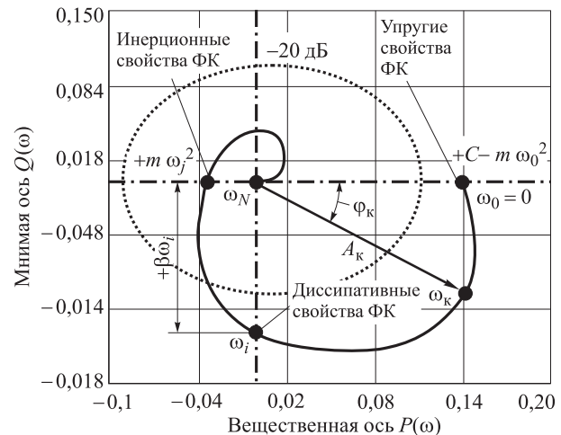
Рис. 3. Интерпретация амплитудно-фазочастотной характеристики с точки зрения упруго-диссипативных свойств трибосистемы: m — масса активных микрообъемов, участвующих в трении; \beta — эквивалентный коэффициент демпфирования; C — коэффициент упругих свойств фрикционного взаимодействия; \omega_N — частота Найквиста
