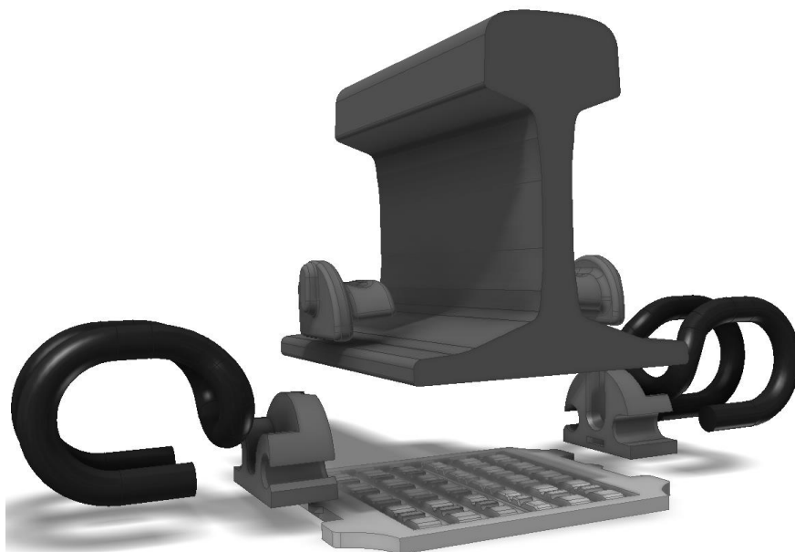
Fig. 3. Geometric models of components of rail fastening type SB-3 Rys. 3. Modele geometryczne elementów mocowania typu SB-3
