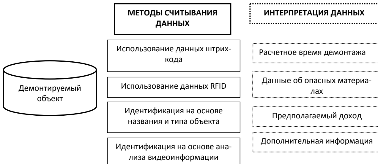
Рис. 4. Концепция системы получения и интерпретации данных о демонтируемом объекте
